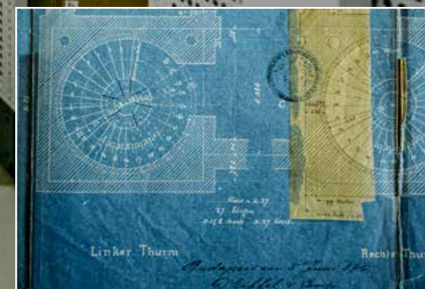
A Nyugati Pályaudvar torony csigalépcsőjének terve, az Eiffel cég tervezőjének aláírásával
